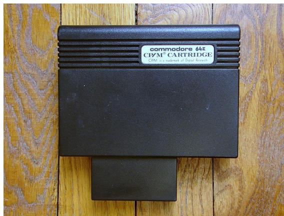
Slika 8 Kertridž sa CP/M operativnim sistemom za Commodore 64 računar
