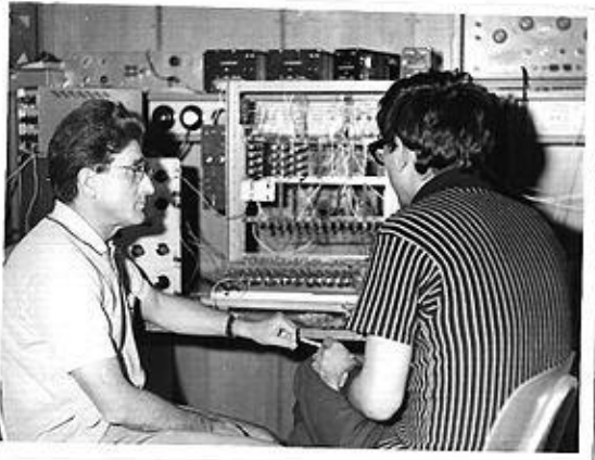
Slika 11 HRS-100 se testira na IMP-u Beograd
