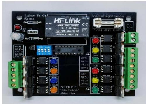
Slika 5. Kontroler u automatskom semaforu
