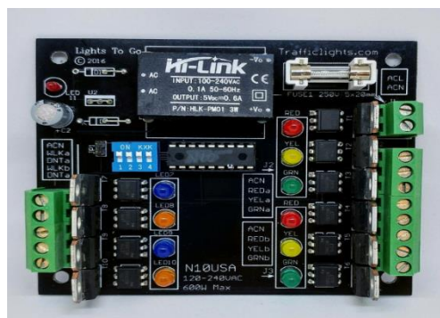
Slika 5. Kontroler u automatskom semaforu
